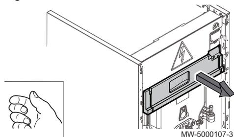
7. Retirer l'isolation logée sous le tableau de commande.
