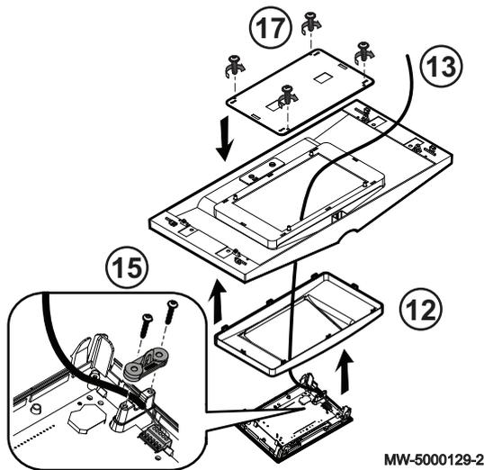
10. Mettre en place la façade du tableau de commande.
