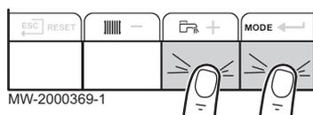
Appuyer sur n'importe quelle touche pour allumer le rétro-éclairage de l'écran du tableau de commande.
