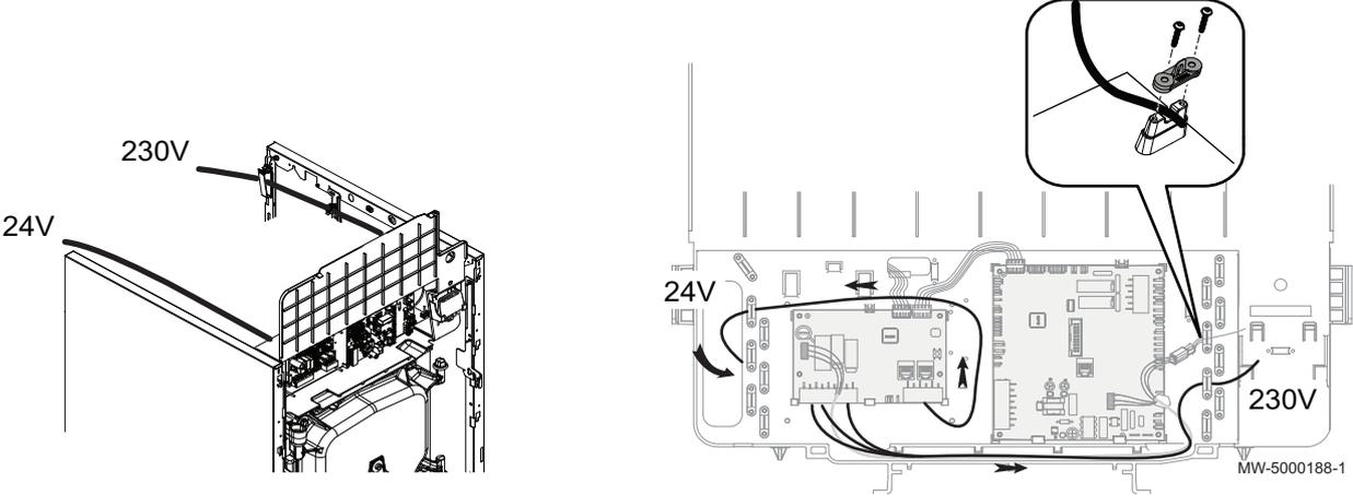
10. Fixer le (ou les) câble(s) à l'aide des arrêts de traction.
