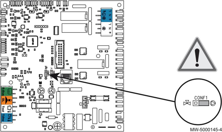
Modifier (si nécessaire) la position du cavalier en fonction du type d'installation.
