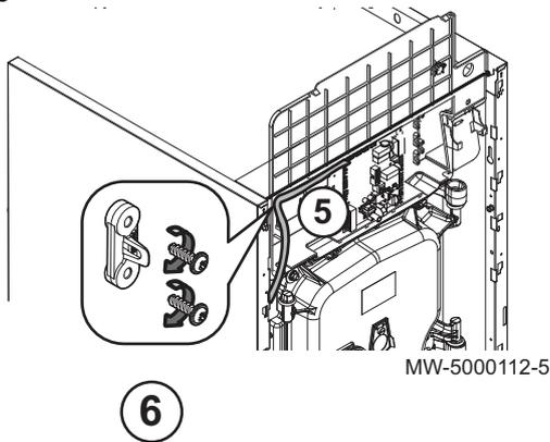
4. Mettre en place le serre-câbles à l'aide des vis cruciformes (pièces fournies dans le sachet du tableau de commande).
